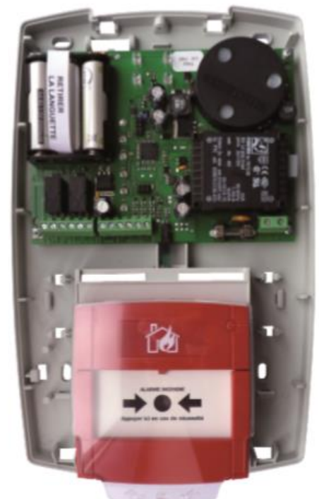
Remplacement des piles usagées
